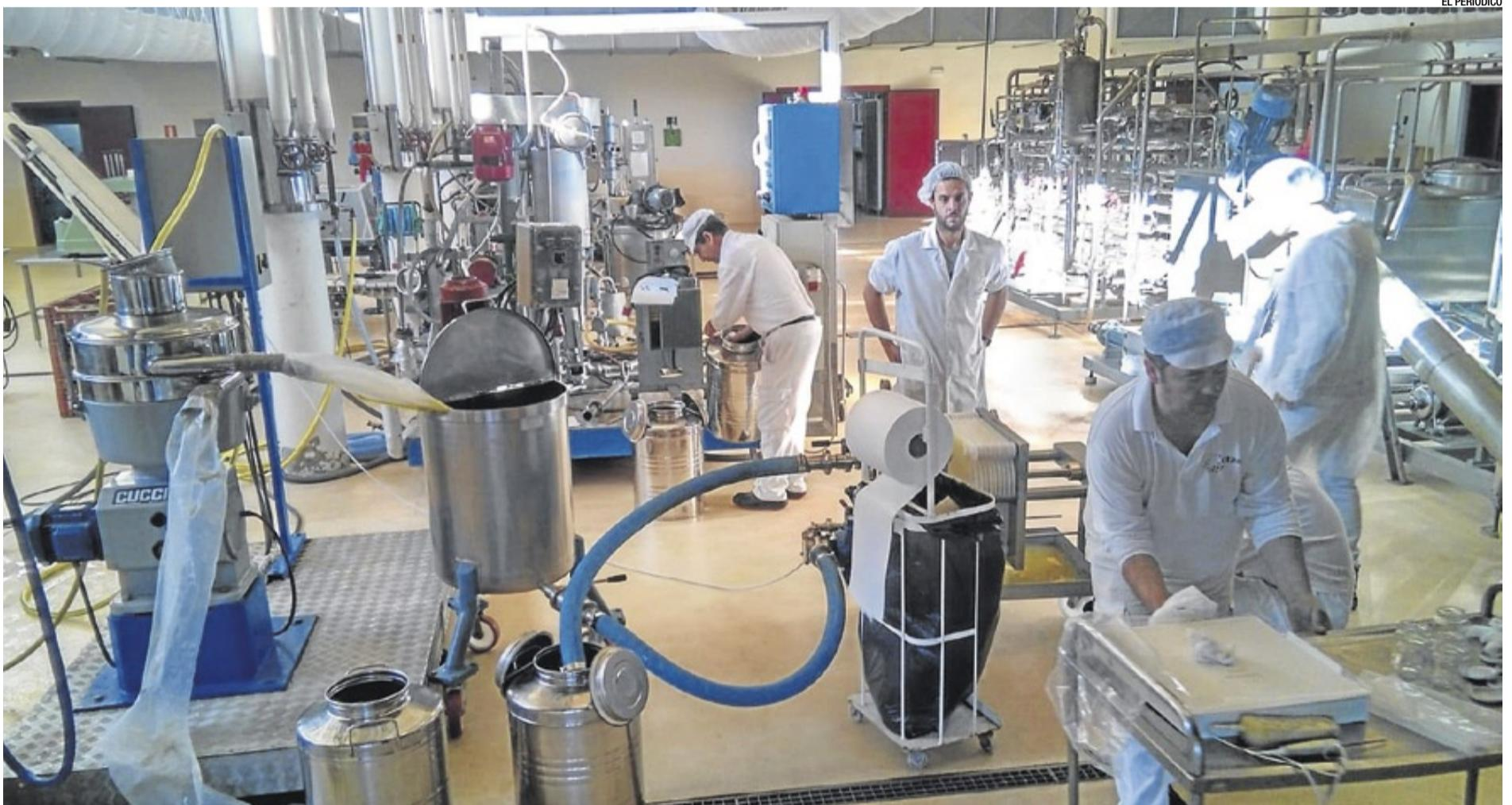
**Planta piloto del Centro Tecnológico Agroalimentario de Extremadura.** Ensayos para determinar el efecto del filtrado sobre la calidad del aceite.
